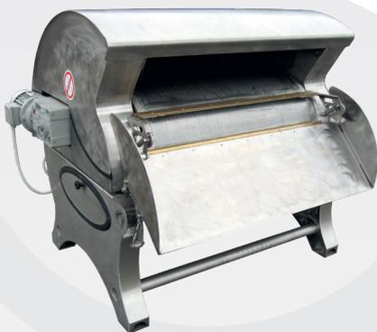
Der Beerepot BSR-2000 ist ein Rollenseparator, der die festen und flüssigen Bestandteile durch ein innovatives Rollensystem voneinander trennt. Im Vergleich zum Schneckenseparator zeichnet sich der Rollenseparator BSR-2000 durch einen höheren Durchsatz aus.
